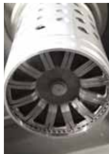
Auch die Spannmembran ist als Leichtbaukonstruktion ausgeführt und sorgt so für einen optimalen Rundlauf des Getriebetopfs.
